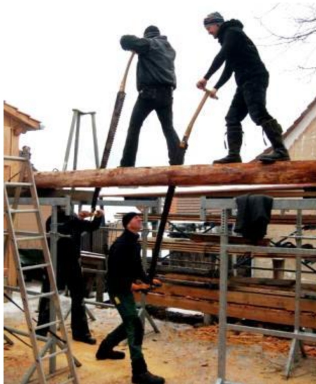
Die Schneidetechnik mit der Klobsäge (alte Klobsägen sind in einen Rahmen eingespannt)
